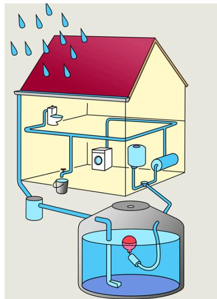
Tout d'abord l'eau est captée sur les toitures puis filtrée et stockée dans la cuve pour être refiltrée et finalement distribuée vers les sorties. La gestion des déchets doit aussi être prise en compte.
